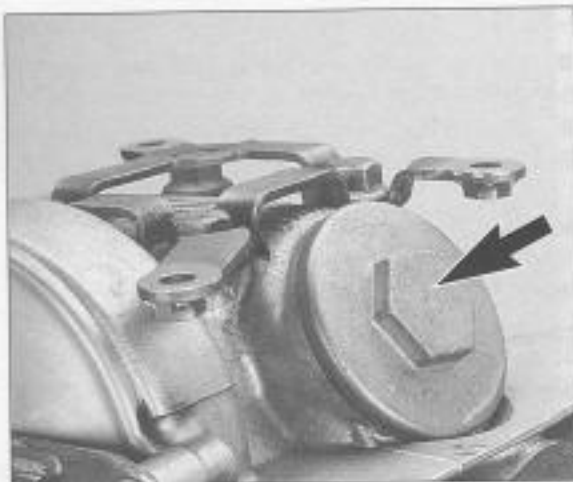
Bild 18 Ventileinstellöffnungen (1 von 2)
