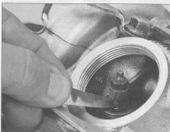
Bild 22 Ventilspiel mit Fühlerlehre prüfen
