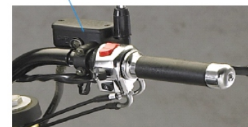
Бачок с тормозной жидкостью
