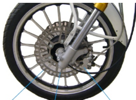
Тормозной диск Левая метка износа Суппорты тормоза (левого)
